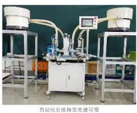
据介绍，设备实现了轮子与轴承同时自动上料，并传输物料至相应的机构进行自动压装，压装完成后自动出料的一体化控制设备。该设备能实现全自动化生产，降低用工成本，提高装配精度与生产效率，大大提升了企业经济效益。
