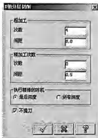
图 3-71 X轴分层切削设置
