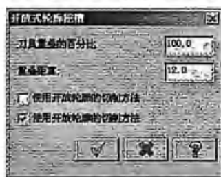
图 3-50 开放式轮廓挖槽设置
