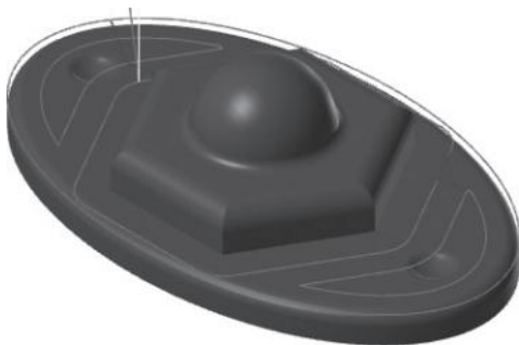
图 8-19 曲面挖槽精加工刀路
