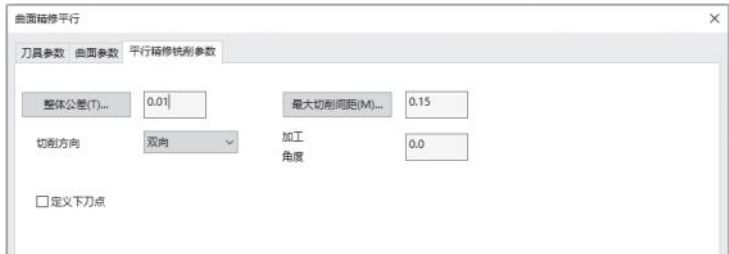
图 8-46 平行精修铣削参数设置
