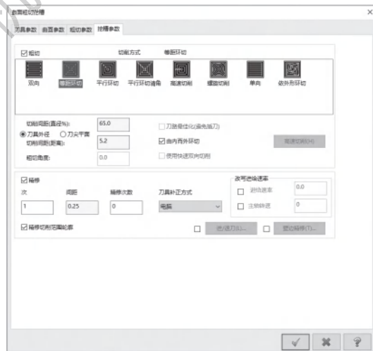
图 4-43 挖槽参数设置
