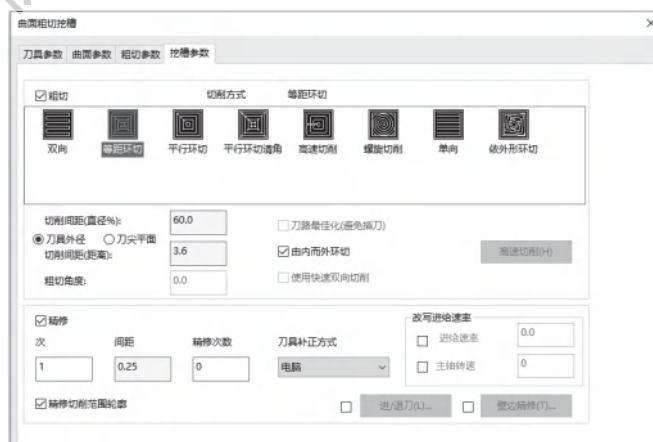
图 9-28 挖槽参数设置
