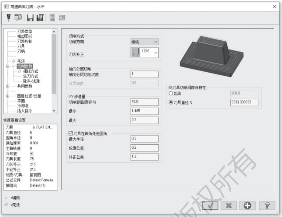
图 7-24 设置切削参数
