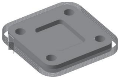
图 10-37 凹模最大轮廓粗加工刀路
