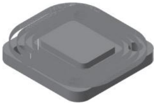
图 10-18 轮廓铣削精加工刀路
