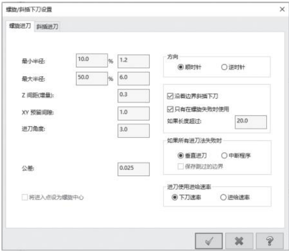
图 4-14 螺旋式下刀参数设置
