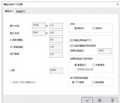
图 9-19 螺旋式下刀设置
