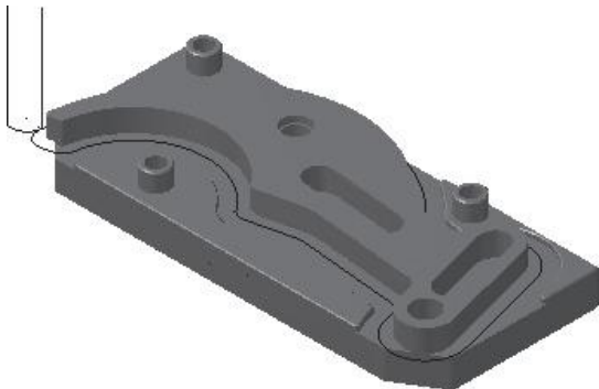
图 7-60 外侧外形铣削精加工刀路
