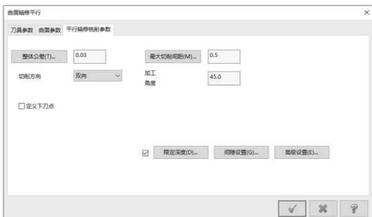
图 9-11 平行精修铣削参数设置
