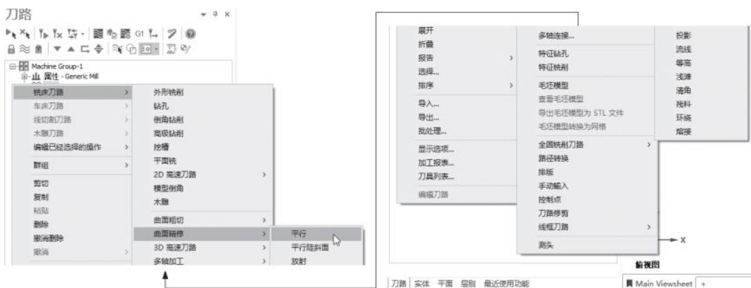
图 6-54 选择曲面平行铣削精加工刀路
