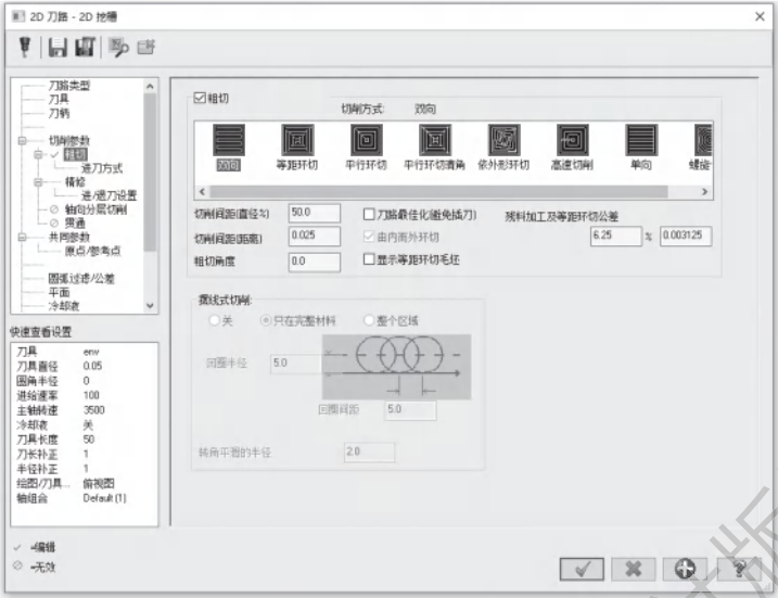
图 8-66 设置粗加工参数
