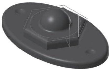
图 8-13 曲面挖槽精加工刀路
