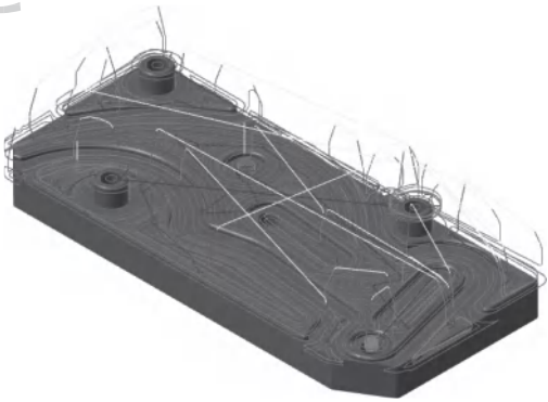
图 7-25 水平区域精加工刀路
