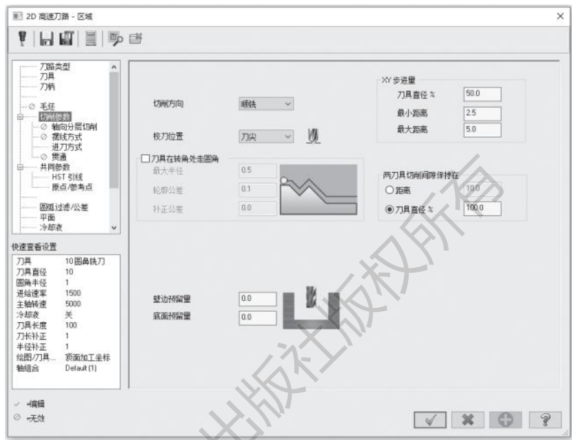
图 5-50 设置切削参数
