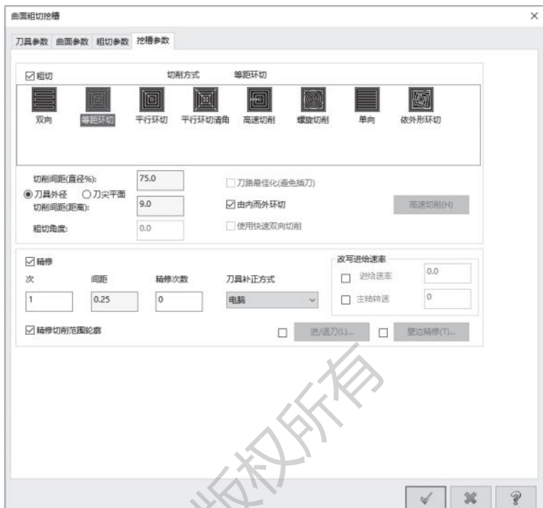
图 8-8 挖槽参数设置
